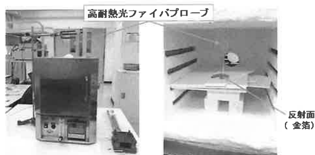
図11 電気炉内でのプローブを用いたレーザ分光計測
