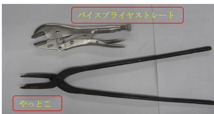
参照図 2 競技材運搬具 (横持ちトレイ・バイスプライヤストレート・やつとこ)
