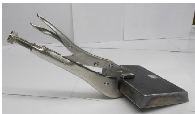
参照図 4 バイスプライヤストレートを使用する事例 (注：厚板の例)
