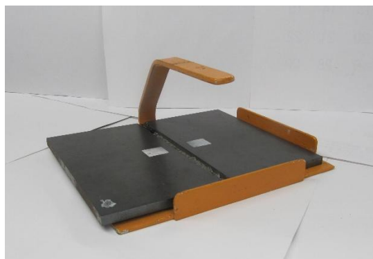
参照図 3 横持ちトレイを使用する事例 (溶接された競技材 注：中板の例)
