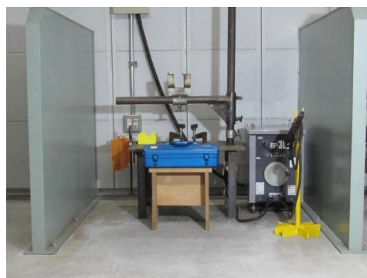
被覆アーク溶接機ブース
